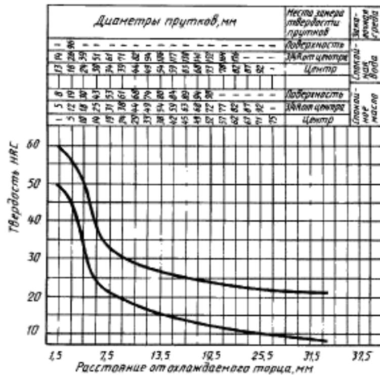
ПАРАМЕТРЫ МАРОЧНЫХ ПОЛОС (ПРЕДЕЛЫ КОЛЕБАНИЙ ТВЕРДОСТИ HRC (HRC<sub>2</sub>) И HRB ПО ДЛИНЕ ТОРЦЕВОГО ОБРАЗЦА)
